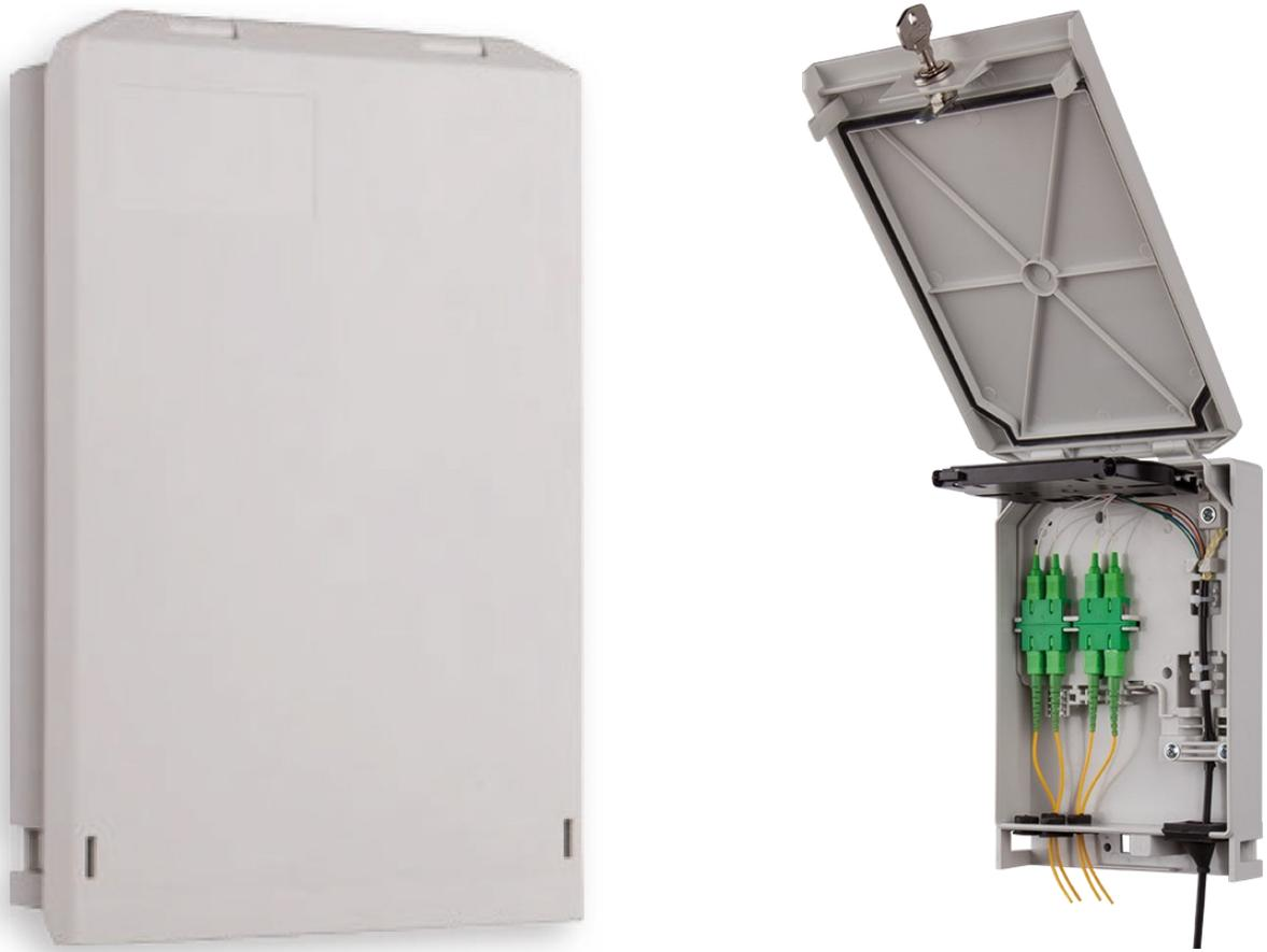
Die telebox FTTX 8F kann sowohl im Innen- als auch im Außenbereich eingesetzt werden. Sie erfüllt den Schutzgrad IP 54. Die Box ist abschließbar und bietet eine Aufnahme bis zu 8 LWL Stecker. Abgeschlossen werden können SC, LC und E-2000 Stecker in verschiedenen Bauformen. Für die Abdichtung der Patchkabel werden geteilte Abdichtungen eingesetzt. Es werden die folgenden Konfigurationen angeboten:
